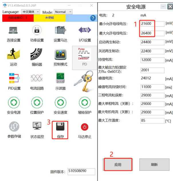
图 4-1 使用 DC24V 供电电源设定举例
