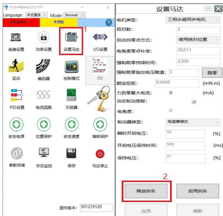
图 8-2 连接上位机释放刹车
